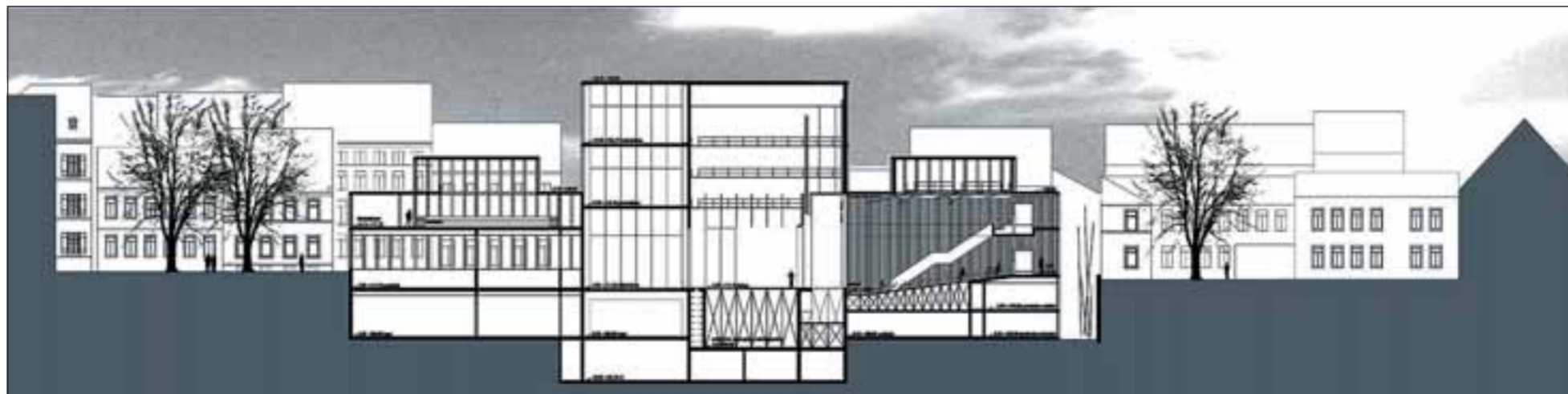
Direktansicht auf das umgebaute Theater von der Theaterstraße aus: Schnitt durchs Gebäude von links: Erster Gebäudeteil: Lager, Werkstätten, Orchesterprobenraum (von unten nach oben), zweiter Gebäudeteil: Bühnenturm mit Probebühnen und dritter Gebäudeteil: neuer Zuschauerraum. Alle Pläne und Skizzen: Waechter+Waechter/Bearbeitung: RNZ-Repro
